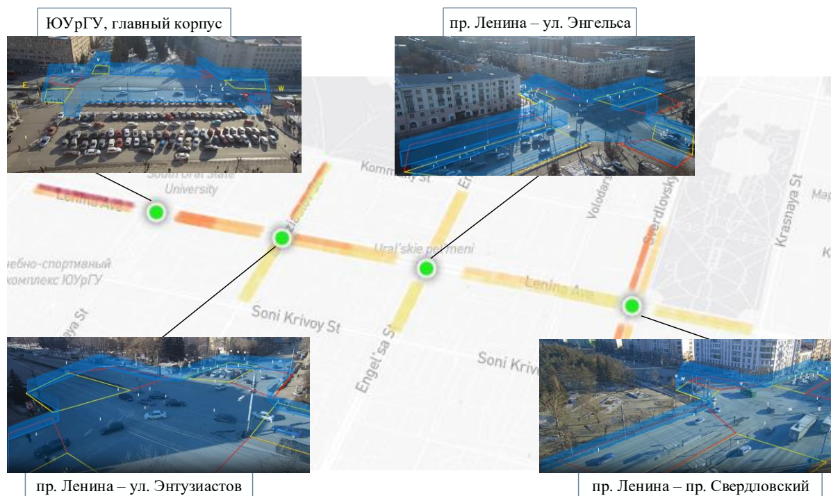
Рисунок 2.5 – Обнаружение и отслеживание АТС сверточной нейронной сетью «AIMS есо» г. Челябинск
