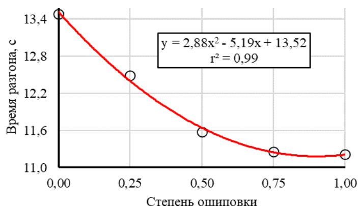
Рисунок 3.10 – Влияние степени ошиповки на время разгона на ледяном покрытии
