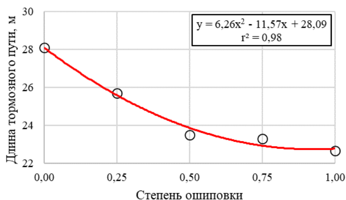
Рисунок 3.16 – Влияние степени ошиповки на тормозной путь на уплотнённом снегу
