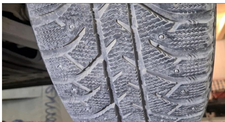
Рисунок 3.46 – Пример изображения шины, полученного в процессе сканирования. Возможно выделение отдельных зон/секторов шины.
