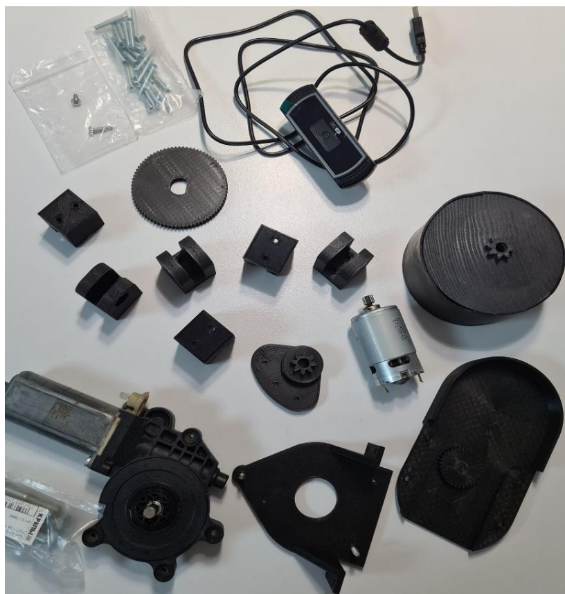
Рисунок 3.29 – Элементы, изготовленные на 3D принтере
