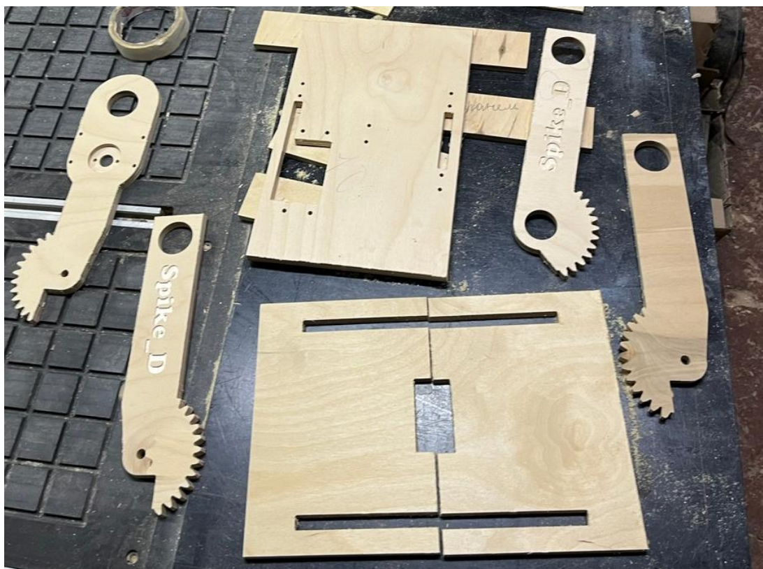
Рисунок 3.30 – Элементы, изготовленные на фрезере с ЧПУ
