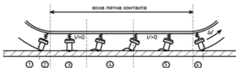
Рисунок 1.6 – Фазы взаимодействия шипа с дорожным покрытием [20]
