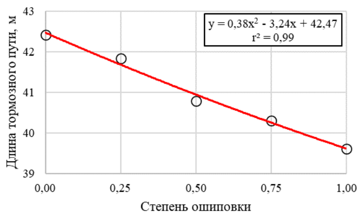
Рисунок 3.18 – Влияние степени ошиповки на тормозной путь на ледяном покрытии
