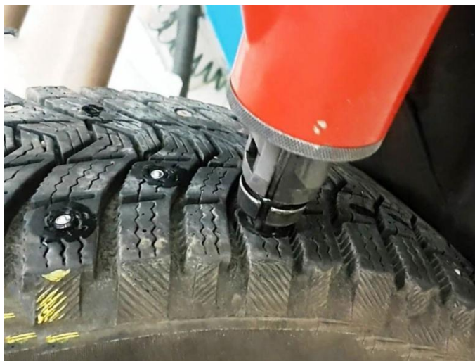
Рисунок 3.6 – Процесс дошиповки колеса
