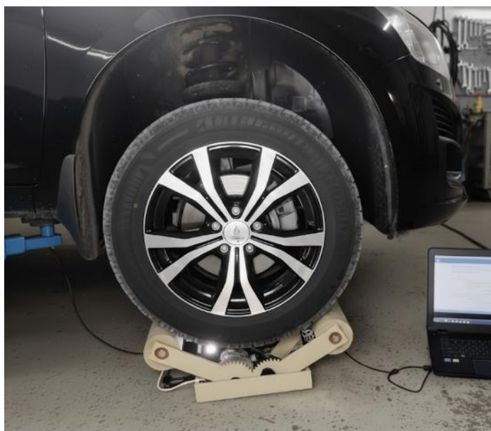
Рисунок 3.45 – Фотография автомобиля, поднятого на подъёмнике, с установленным стендом сканирования под колесом
