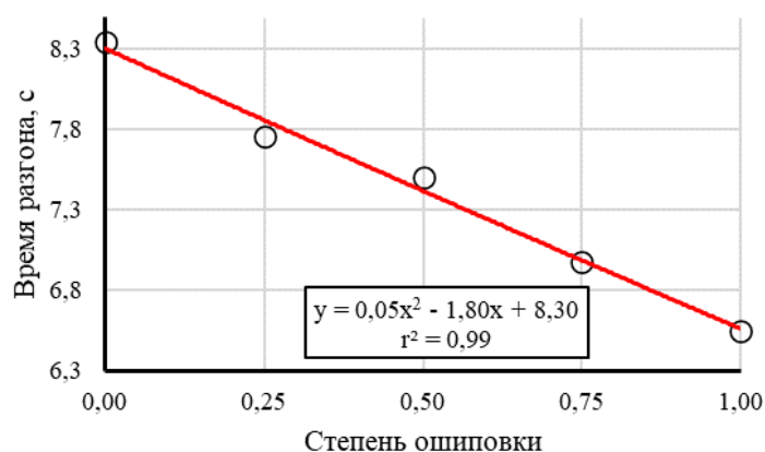
Рисунок 3.13 – Влияние степени ошиповки на время разгона на рыхлом снегу
