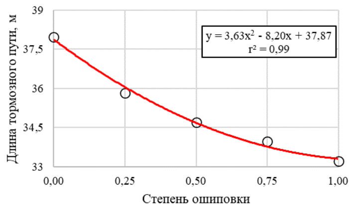
Рисунок 3.17 – Влияние степени ошиповки на тормозной путь на рыхлом снегу
