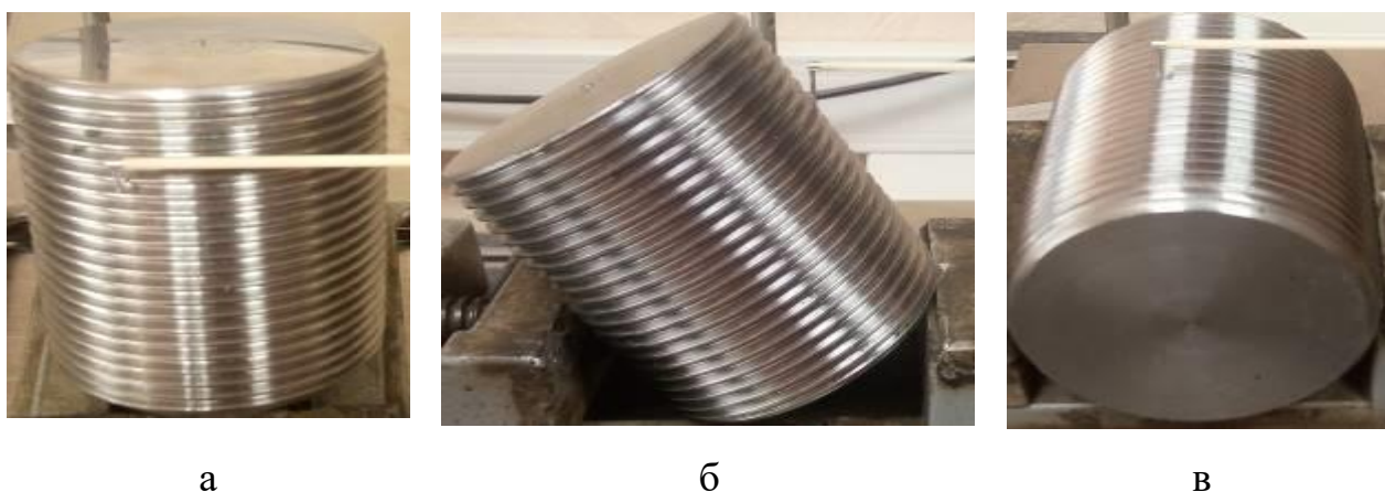
Рисунок 5.7 – Схемы измерения шероховатости: а – в продольном направлении, б – в поперечном направлении, в – по вершине витка
