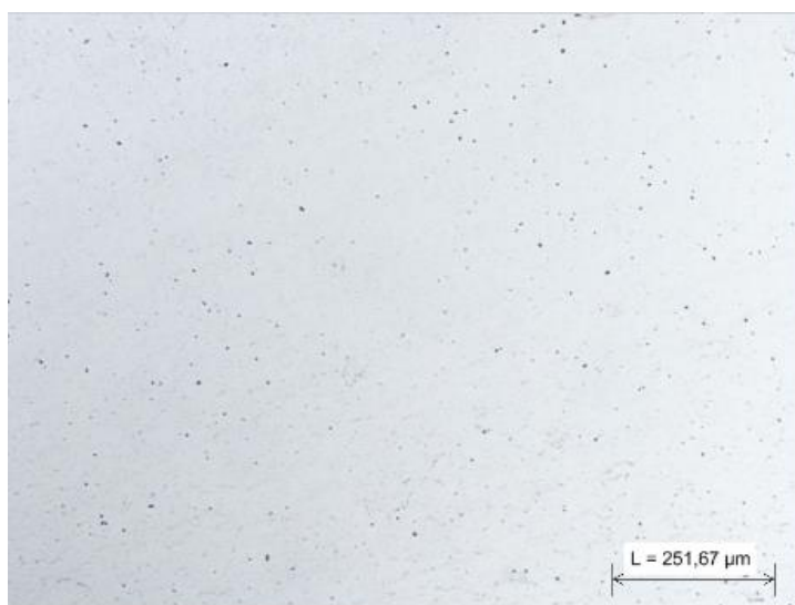
Рисунок 4.8 – Характер распределения пористости в покрытии после оплавления с температуры 1150 °C в водополимерной среде «Термат»
