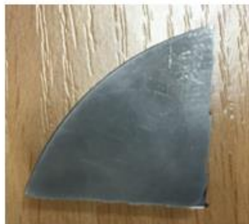
Рисунок 2.2 – Образцы для металлографических исследований, вырезанные с рабочей части штока Dresser-Rand (Германия)
