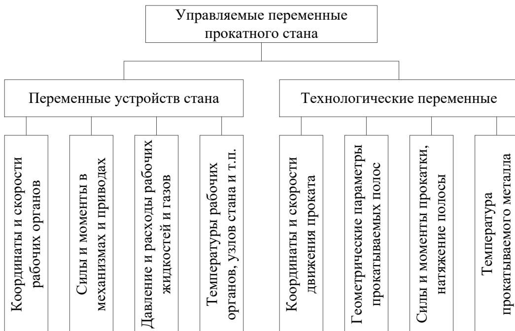
Рисунок 37– Управляемые переменные прокатного стана
