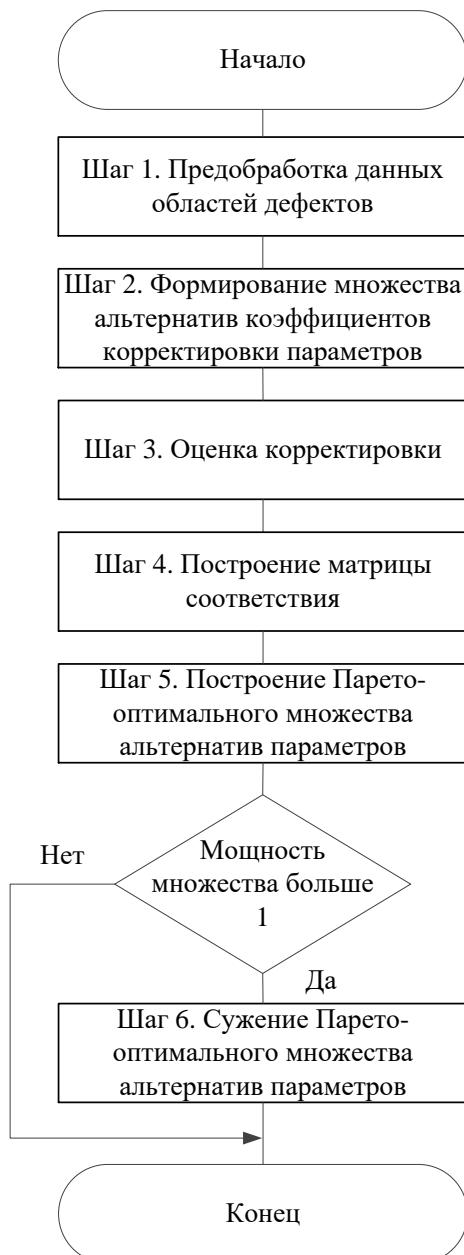
Рисунок 23 – Укрупненная схема алгоритма оценки коэффициентов корректировки задающих параметров прокатки
