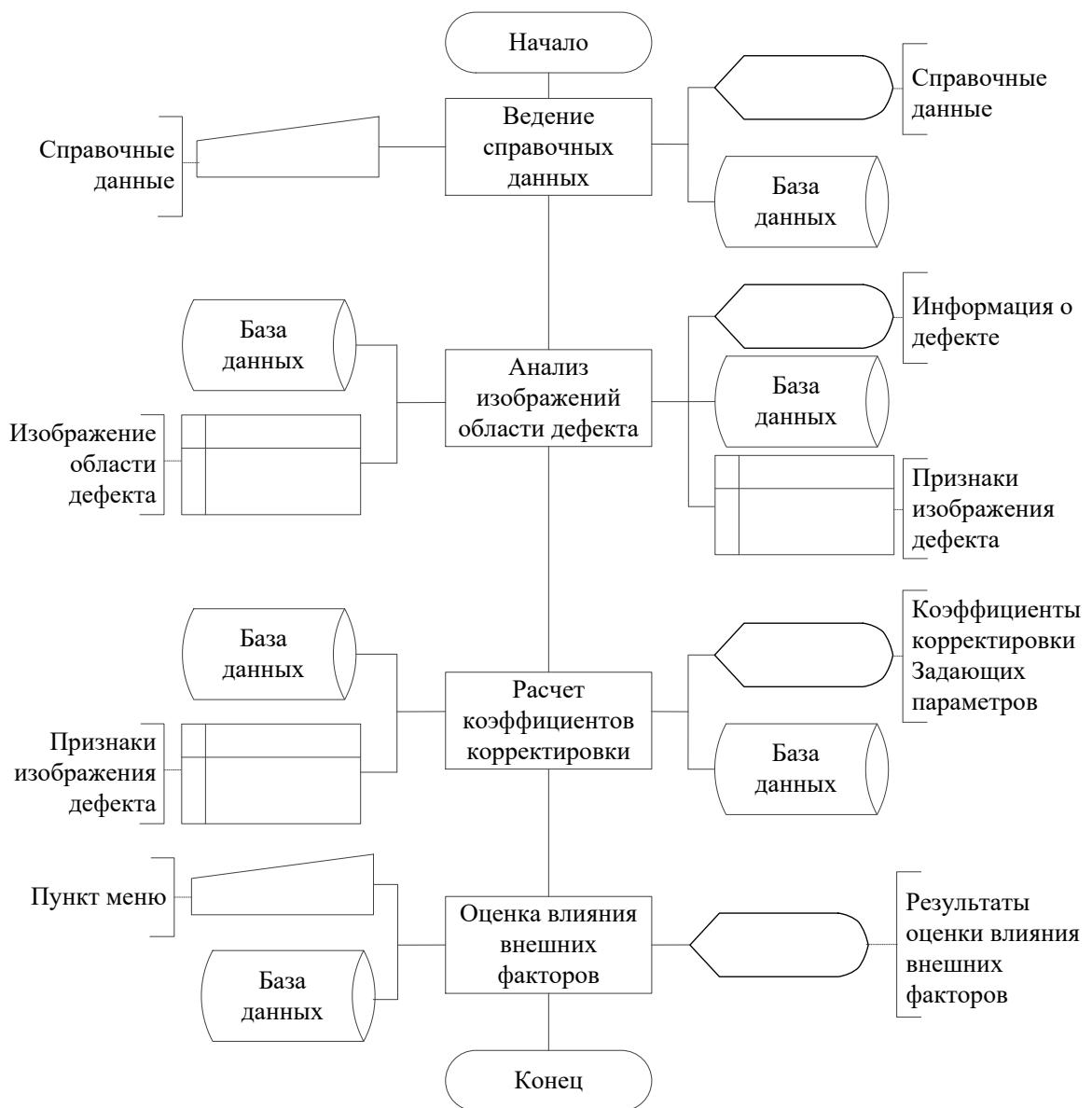
Рисунок 28 – Функциональная схема программного средства
